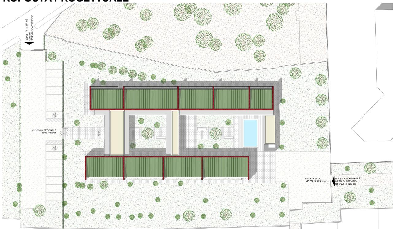
*Pianta delle coperture con indicazione degli accessi*
